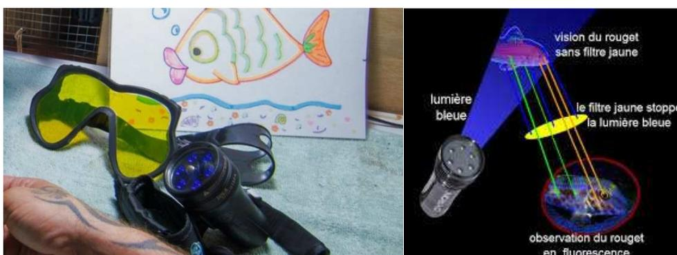
*Matériel (à gauche) et principe (à droite) de la plongée « fluorescente »*
