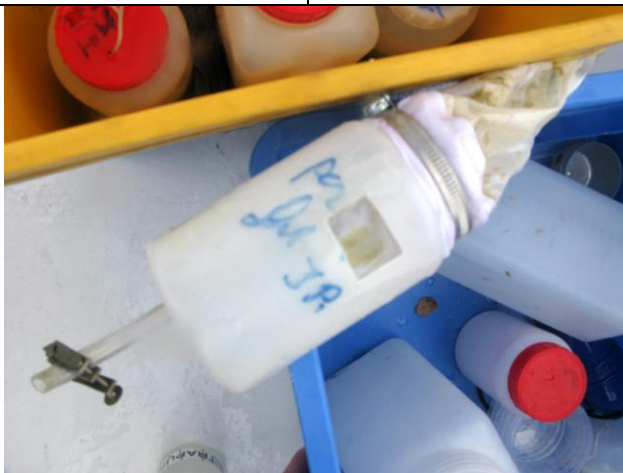
bricolage d'un robinet sur flacon plastique
