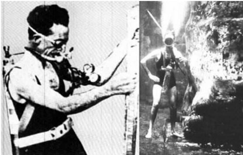
Premiers essais du scaphandre autonome Le Prieur-Fernez (1935). Source Gallica / BNF
